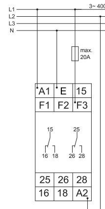
Messbereich 60V mit Powermodul 230V a.c. mit Fehlerspeicher
