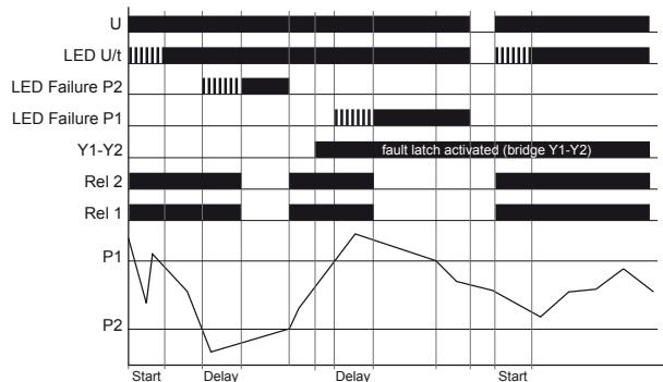
Esempio : Funzione finestra (WIN) – Reset del guasto memorizzato premendo il pulsante di reset
