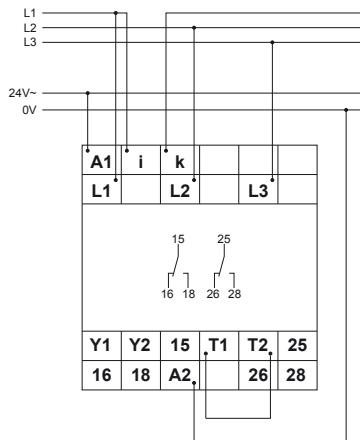
Collegamento rete trifase 400V con modulo alimentazione 400V AC con memorizzazione guasto  $I_N < 12A$
