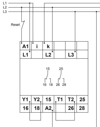
Collegamento rete trifase 400V con modulo alimentazione 400V AC con memorizzazione guasto e trasformatore di corrente  $I_N > 12A$
