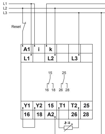
Collegamento rete trifase 400 V con modulo alimentazione 230V AC senza memorizzazione guasto e trasformatore di corrente  $I_N > 12A$
