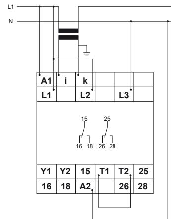
Collegamento rete trifase 400V con modulo alimentazione 400V AC con memorizzazione guasto e controllo temperatura  $I_N > 12A$
