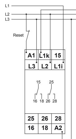
Collegamento carico monofase 230V con modulo alimentazione 230V AC senza funzione memorizzazione guasto
