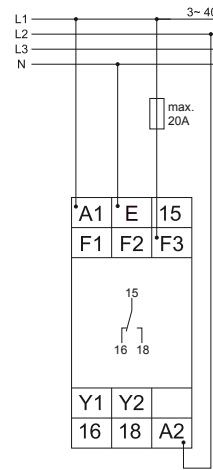
Escala 60V con módulo de tensión 230V AC con memoria de defecto
