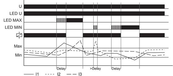
Si se selecciona la función con memoria de defecto (WINDOW+LATCH), el relé de salida permanecerá desconectado después de un disparo por máxima o por mínima intensidad, incluso si la intensidad cae por debajo del valor MAX ajustado o supera el valor MIN ajustado. Sólo después de resetear el fallo (desconectando la tensión de alimentación y volviéndola a conectar), volverá el relé de salida con tiempo de inhibición a la puesta en marcha (Start).
