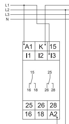
Escala 1A con módulo de tensión 230V AC con memoria de defecto
