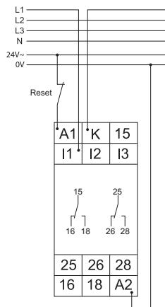
Escala 5A con módulo de tensión 400V AC sin memoria de defecto
