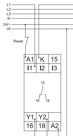
Escala 10A con módulo de tensión 400V AC sin memoria de defecto
