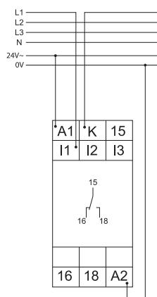
Messbereich 10A mit Powermodul 400V AC
